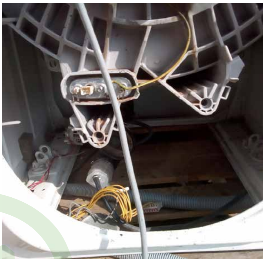
Nekompletní pračka, ve které chybí motor a čerpadlo.
