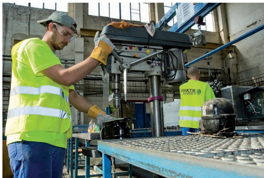
Vypouštění olejové náplně z kompresoru
